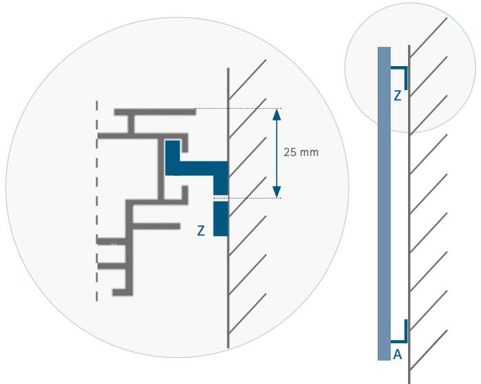
Der Schallsauger wird für eine Wandaufhängung mit einer entsprechenden Anzahl Z-Profil ausgeliefert.
