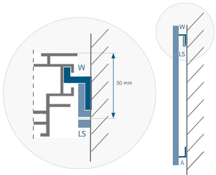
Der Schallsauger wird für eine Wandaufhängung mit einer entsprechenden Anzahl Wandhalter und L-Schienen ausgeliefert.
