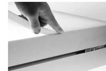
Bedrucktes Tuch mit Silikonkeder einspannen.
